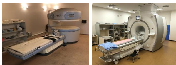
図1 MRI 装置 a | b a 永久磁石型装置 , b 超電導型装置
